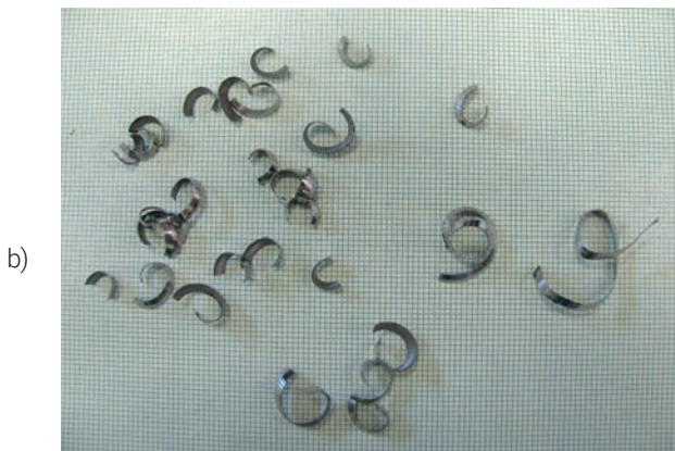
Fig. 4. Chip appearance after turning: a) 11SMnPb37, b) 11SMn30 Rys. 4. Wygląd wiórów po toczeniu: a) 11SMnPb37, b) 11SMn30
